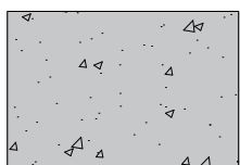
Dalle en béton
