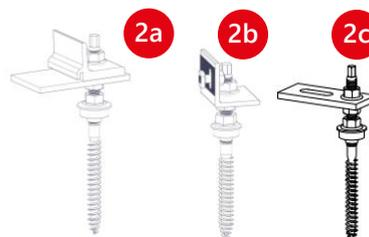
3. Kits Connecteurs de rails [connexion entre 2 rails]
