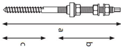
Les vis à double filetage sont disponibles en différentes longueurs et différents diamètres. Elles sont adaptées pour les toitures en fibres-ciment à profil ondulé posées sur une ossature en bois.
