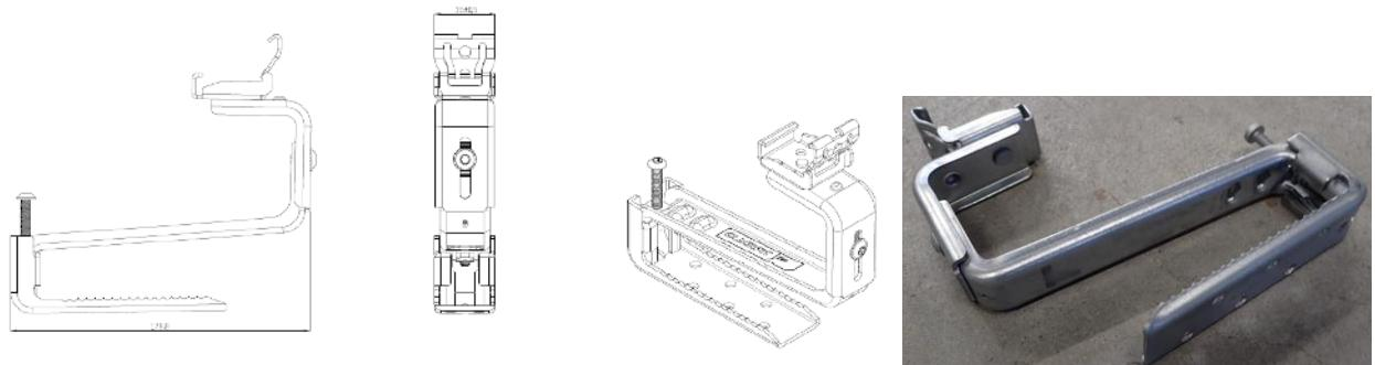
Contrairement aux crochets « Trusshook », les crochets « Universal Hook » sont insérés sur la sous-structure bois sans aucune vis dans le bois : la liaison s'effectue par frottement (ou par pincement).
