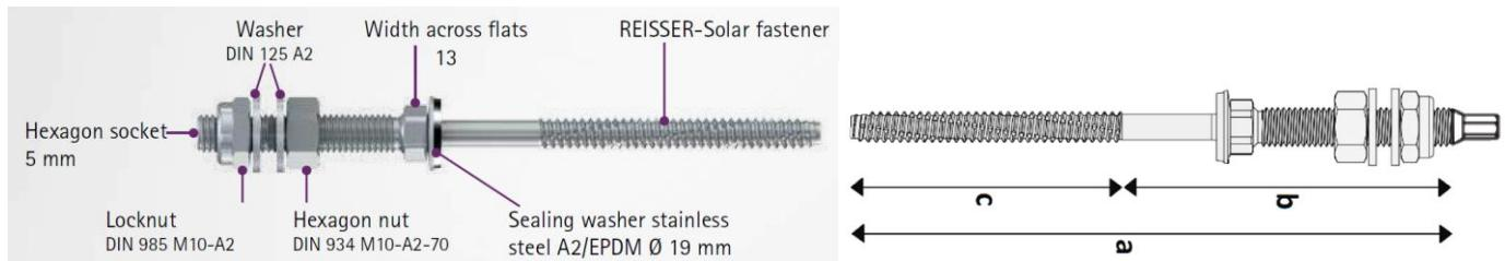
Les vis à double filetage sont disponibles en différentes longueurs et différents diamètres. Elles sont adaptées pour les toitures en fibres-ciment à profil ondulé posées sur une ossature porteuse en acier (pré perçage nécessaire).
